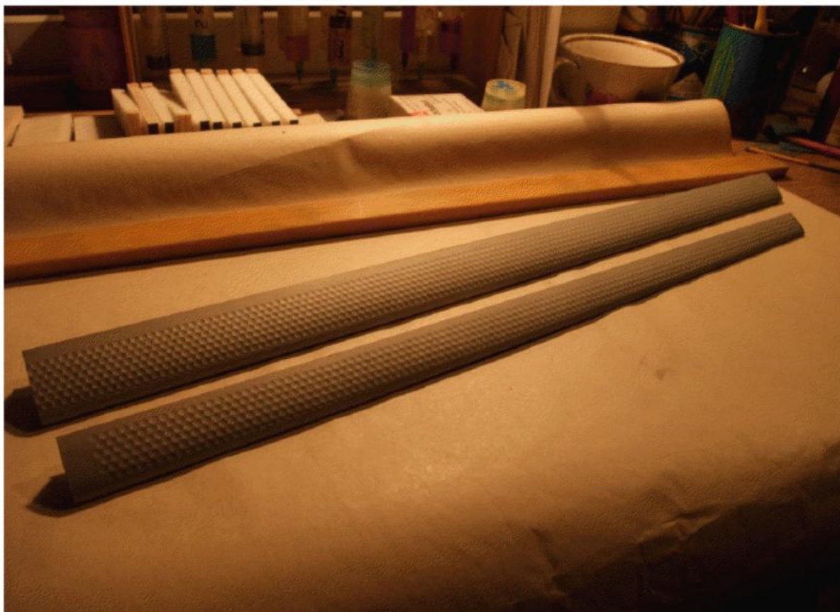
Obr.3 D-box s „umělým zdrsňením typu „golfový míček“.
